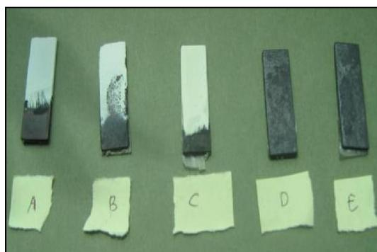
Gambar 5. Hasil *sintering* Substrat SS 316L pada temperatur 900 °C (A), 1000 °C (B&C), 1200 °C (D&E).
