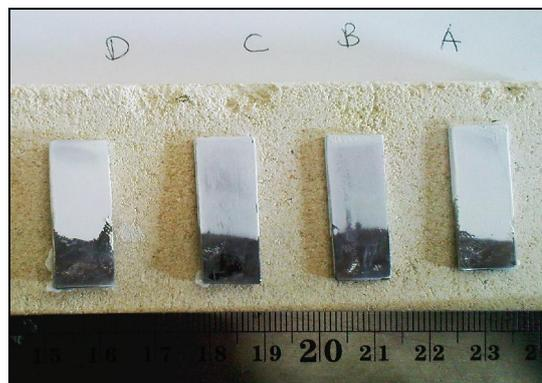
Gambar 3. Hasil pelapisan HA pada substrat dengan metode EPD pada waktu 15 menit (kiri) dan 60 menit (tengah)
